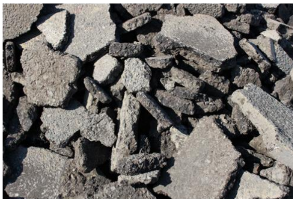
コンクリート・ガラ
